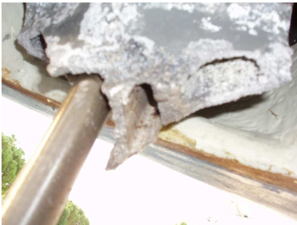
Embase de sail drive sectionnée sous l'effet de la corrosion galvanique
